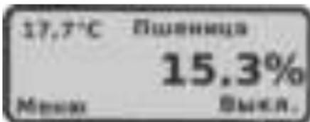
Проведите обычное измерение влажности. Когда результат измерения высветится на дисплее, нажмите кнопку **Menu**.
